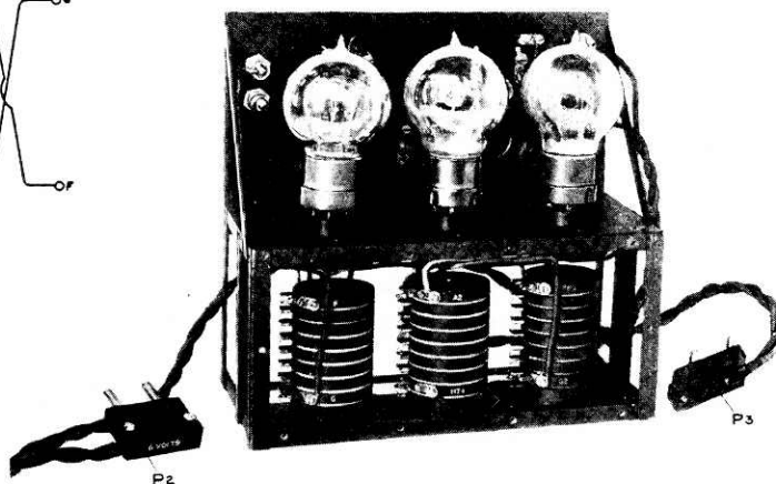
Fig.13 Binnenaanzicht van een type E breedband versterker.
